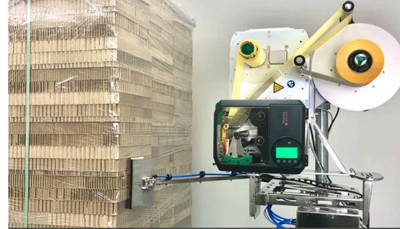
Das Etikett wird mit der XPA 936 bedruckt, das Vakuum-Pad nimmt das Etikett und der Rotor-Long Applikator bringt es mit einer Schwenkbewegung exakt auf die stehende/gestoppte Palette auf.
